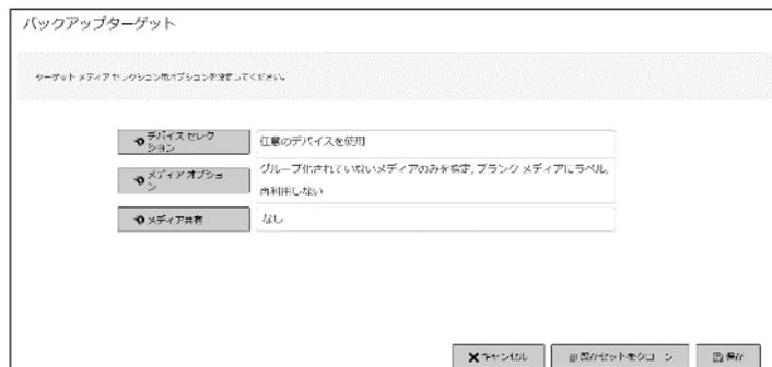
**14** デバイス セレクション画面でデバイスを選択し「設定」をクリック、新規セットの作成画面でセット名を入力し「保存」をクリックします。バックアップ設計によってはドライブの利用制限等もある場合に有効に利用できます。
